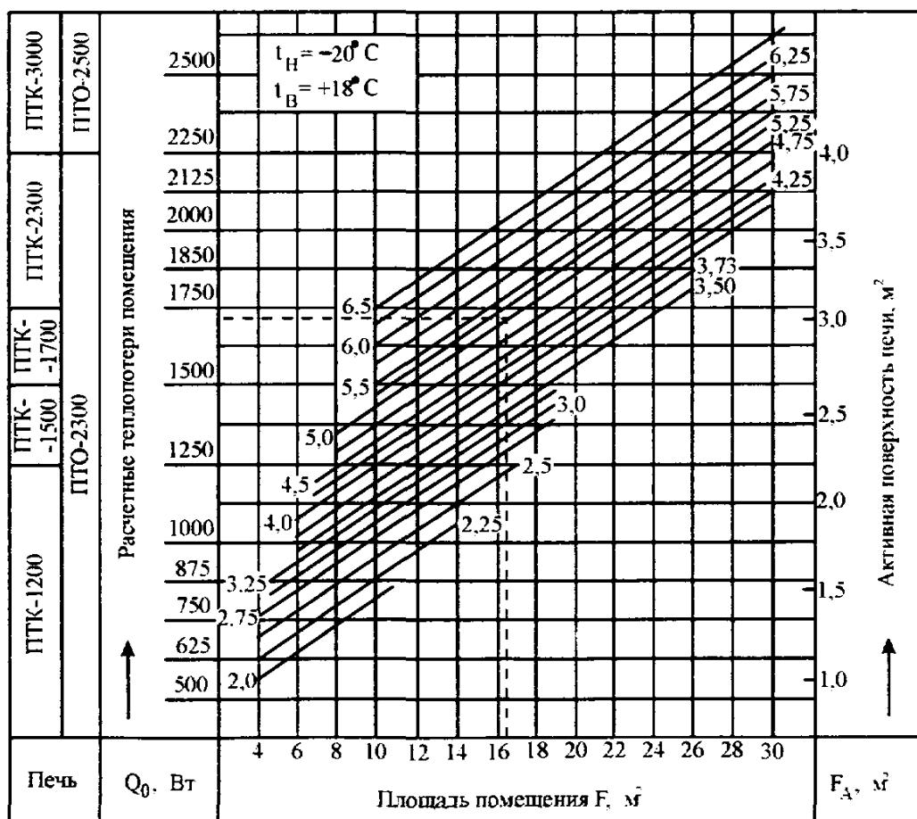
Рис. 3.1. Номограмма для определения теплопотерь неугловых комнат
