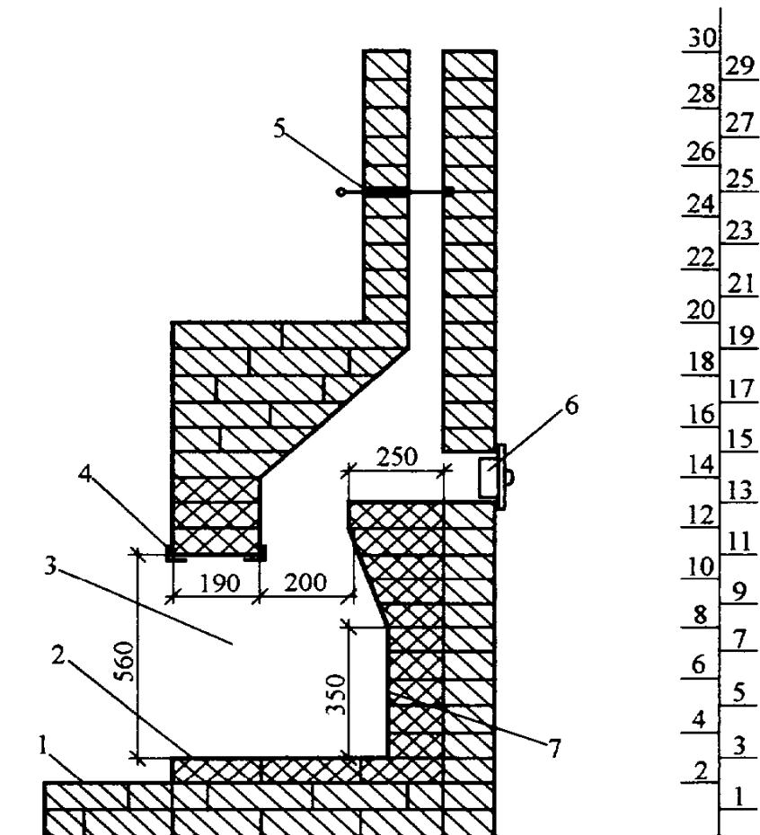
Рис. 5.1. Устройство камина из кирпича:
