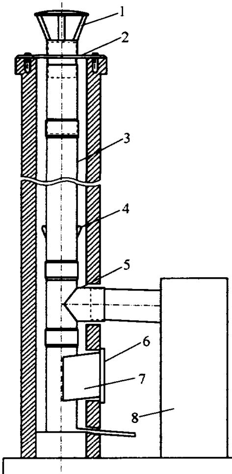
Рис. 6.6. Прокладка трубы в кирпичном канале:
