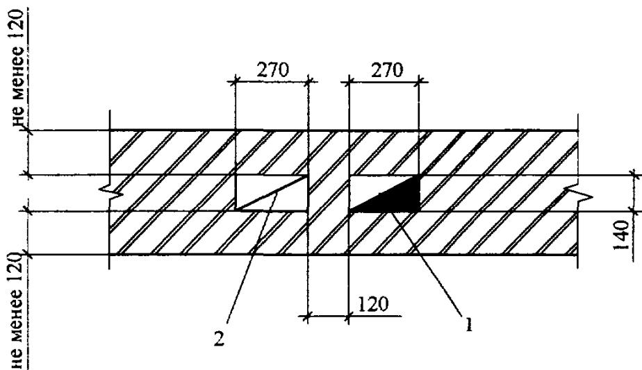
Рис. 6.1. Размещение каналов во внутренней стене:
