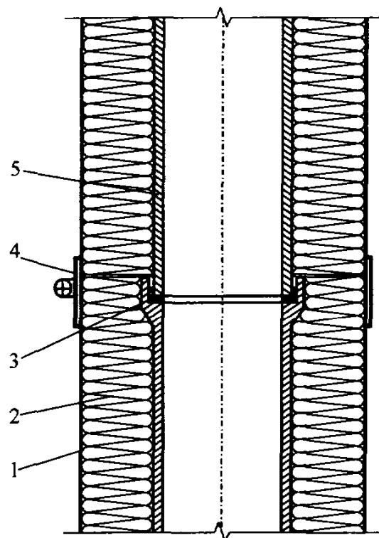
Рис. 6.9. Деталь соединительного стыка дымовой трубы:
