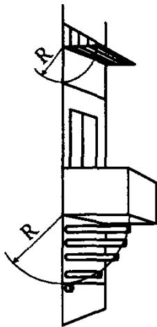
Рис. Г.2. Схема размещения дымового канала под навесом или балконом.
