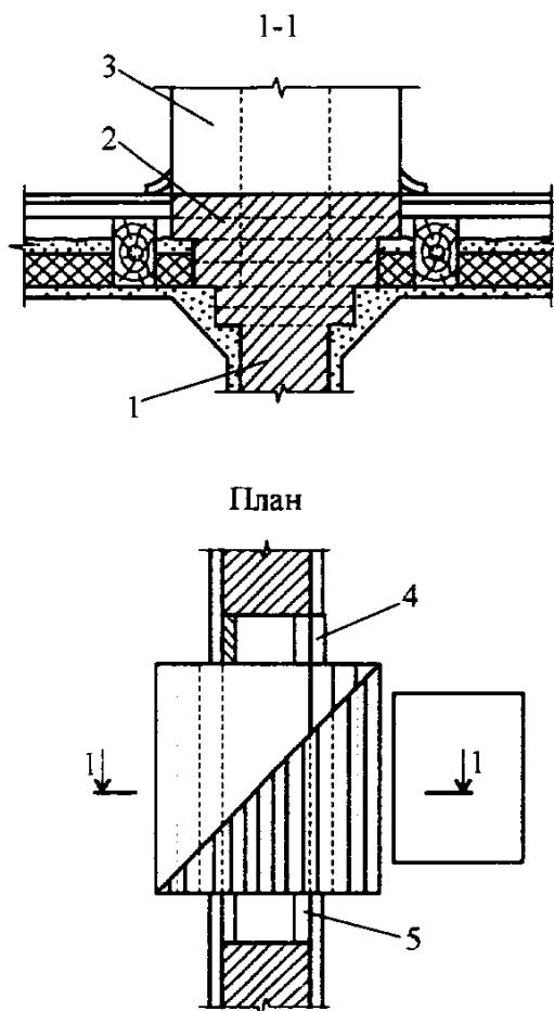
Рис. 3.6. Основание печи на уширении стены:
