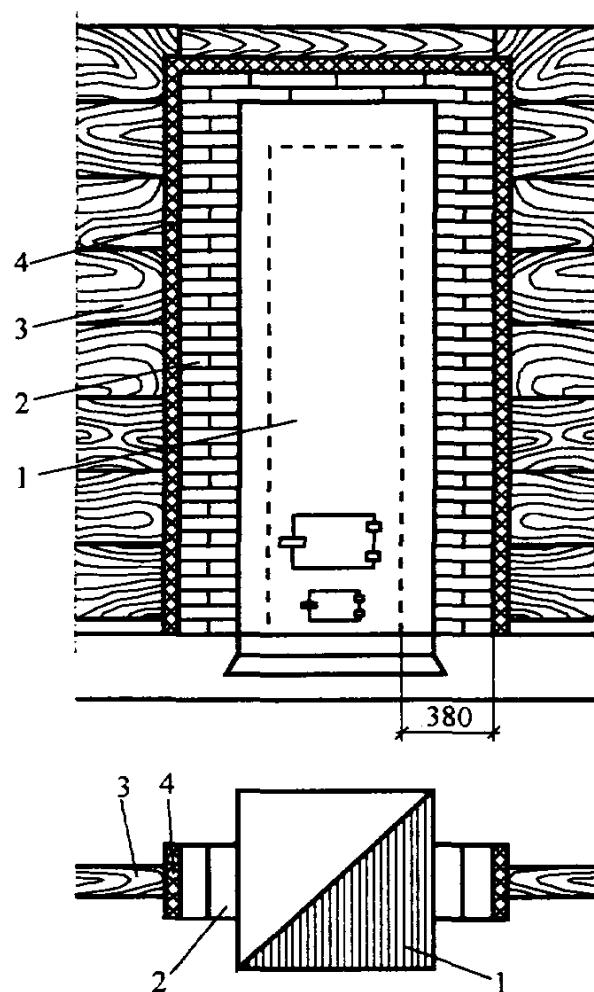
Рис. 3.9. Устройство вертикальной разделки:
