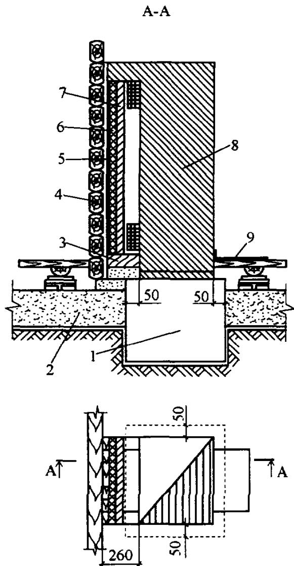
Рис. 3.8. Устройство закрытой отступки:
