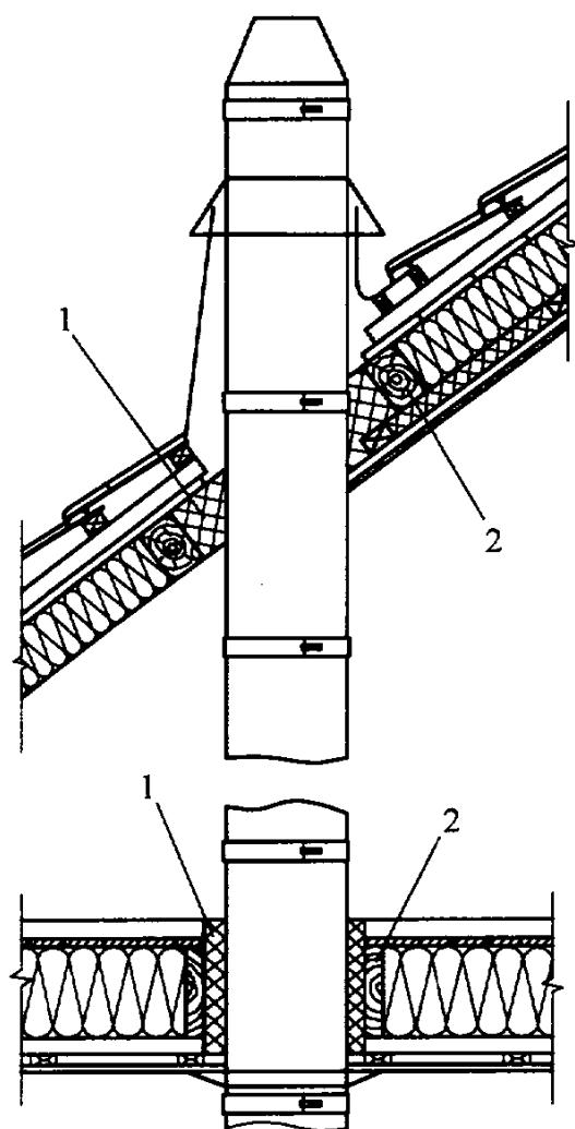
Рис. 6.14. Схема противопожарной разделки:
