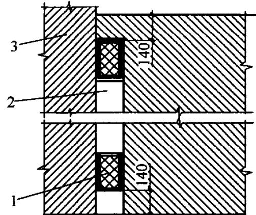
Рис. 3.7. Схема размещения вентиляционных решеток:
