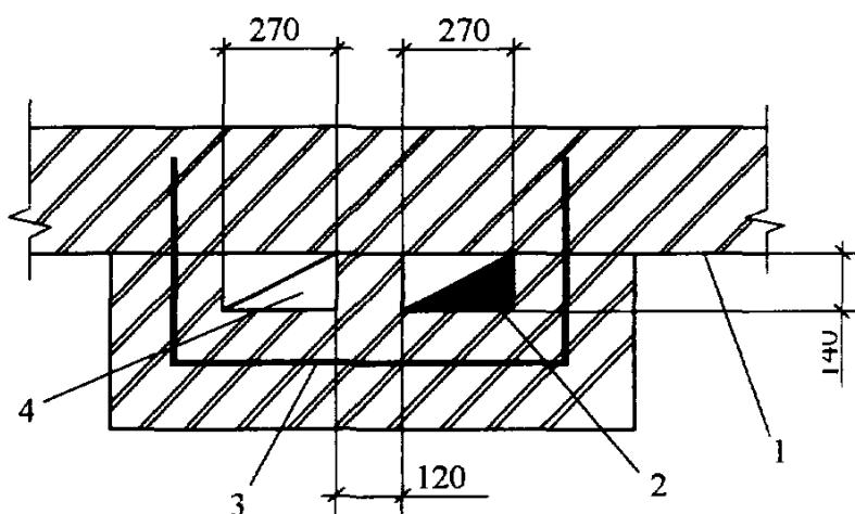
Рис. 6.4. Пристроенные каналы к наружной кирпичной стене:
