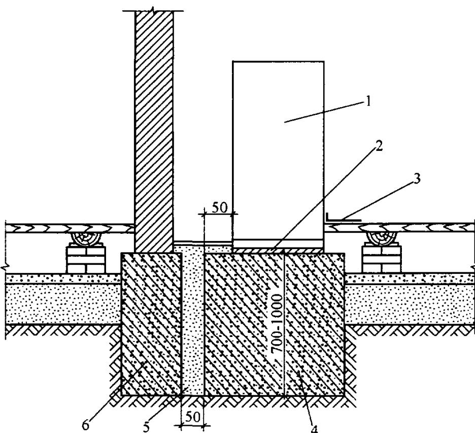
Рис. 3.4. Размещение печи на отдельном фундаменте:
