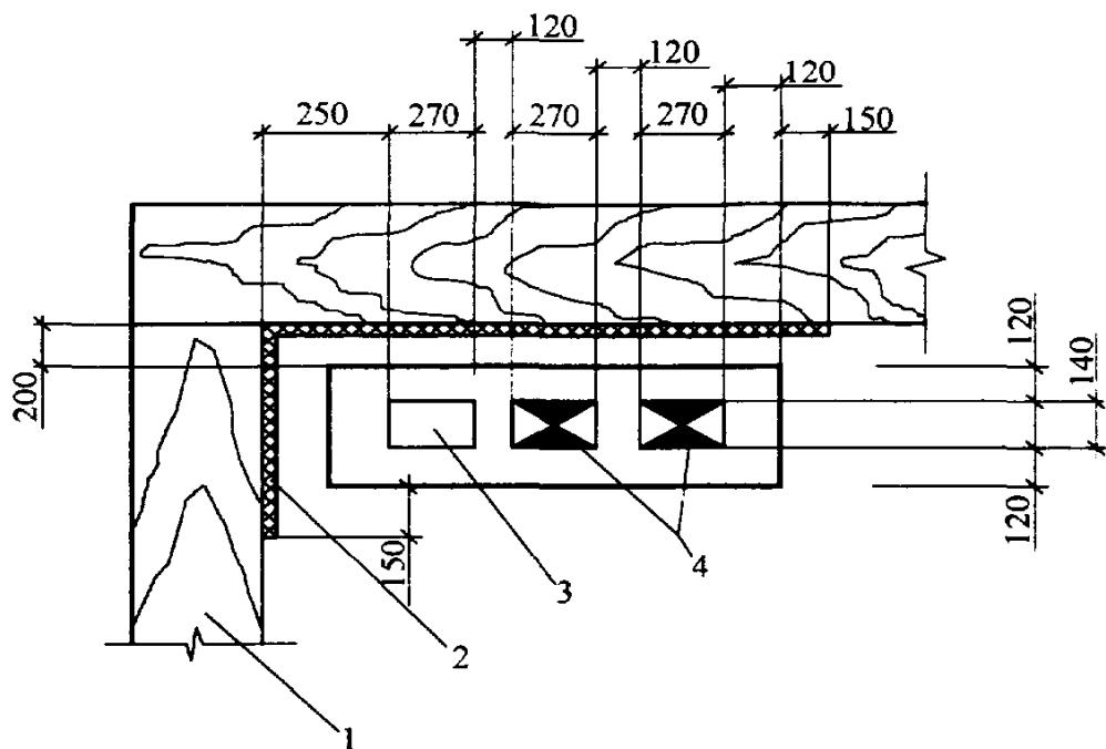
Рис. 6.11. Устройство отступки:
