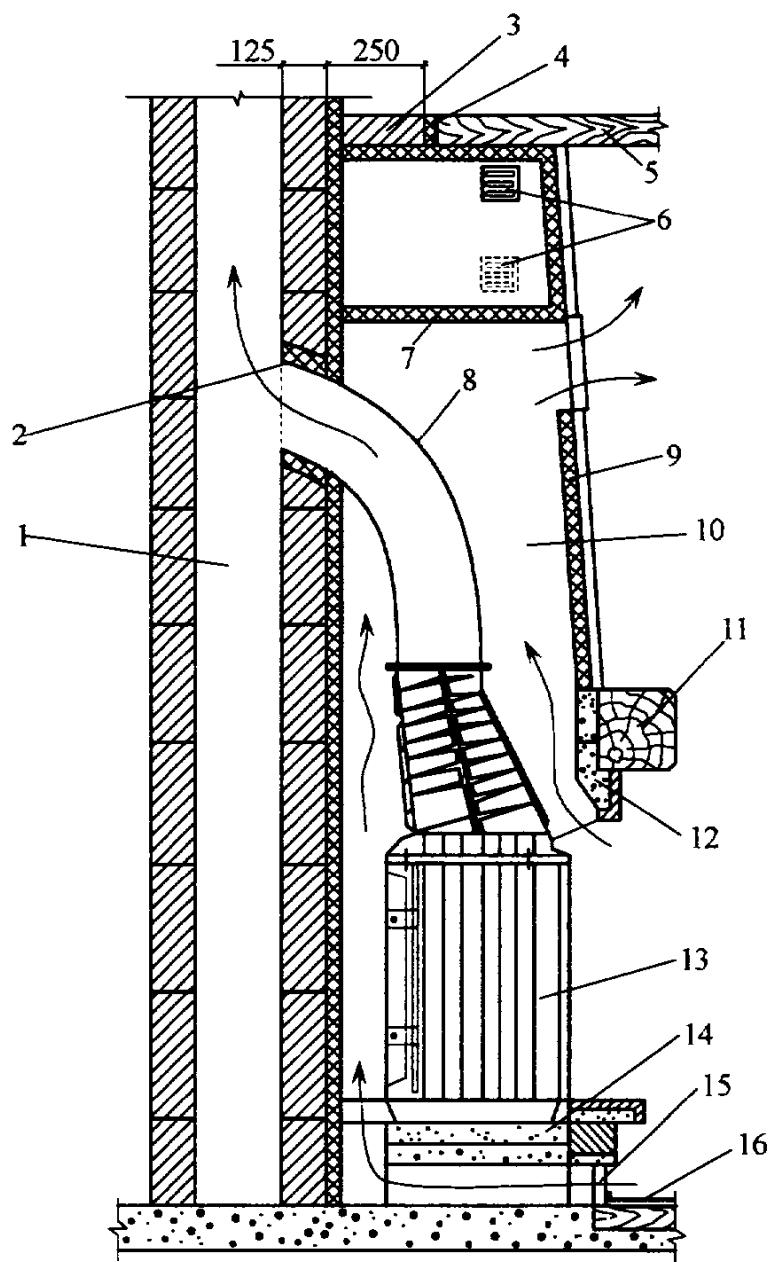
Рис. 5.4. Устройство камина закрытого типа:
