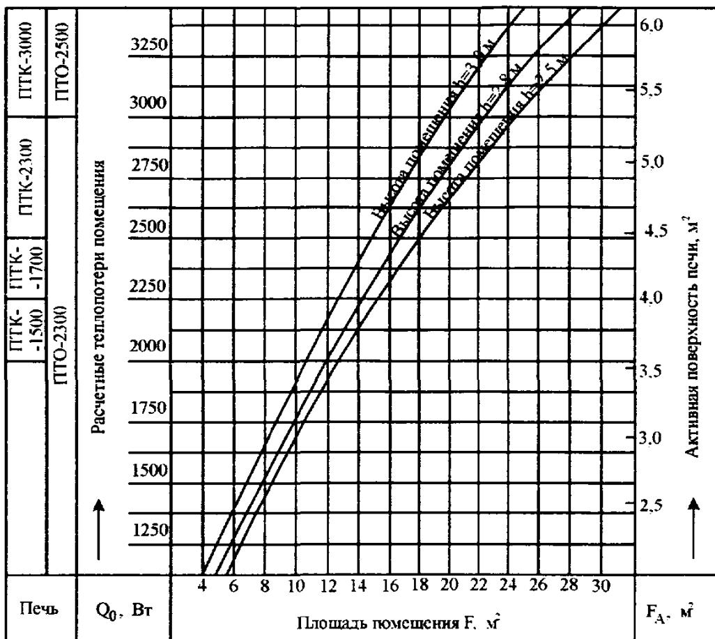
Рис. 3.2. Номограмма для определения теплопотерь угловых комнат
